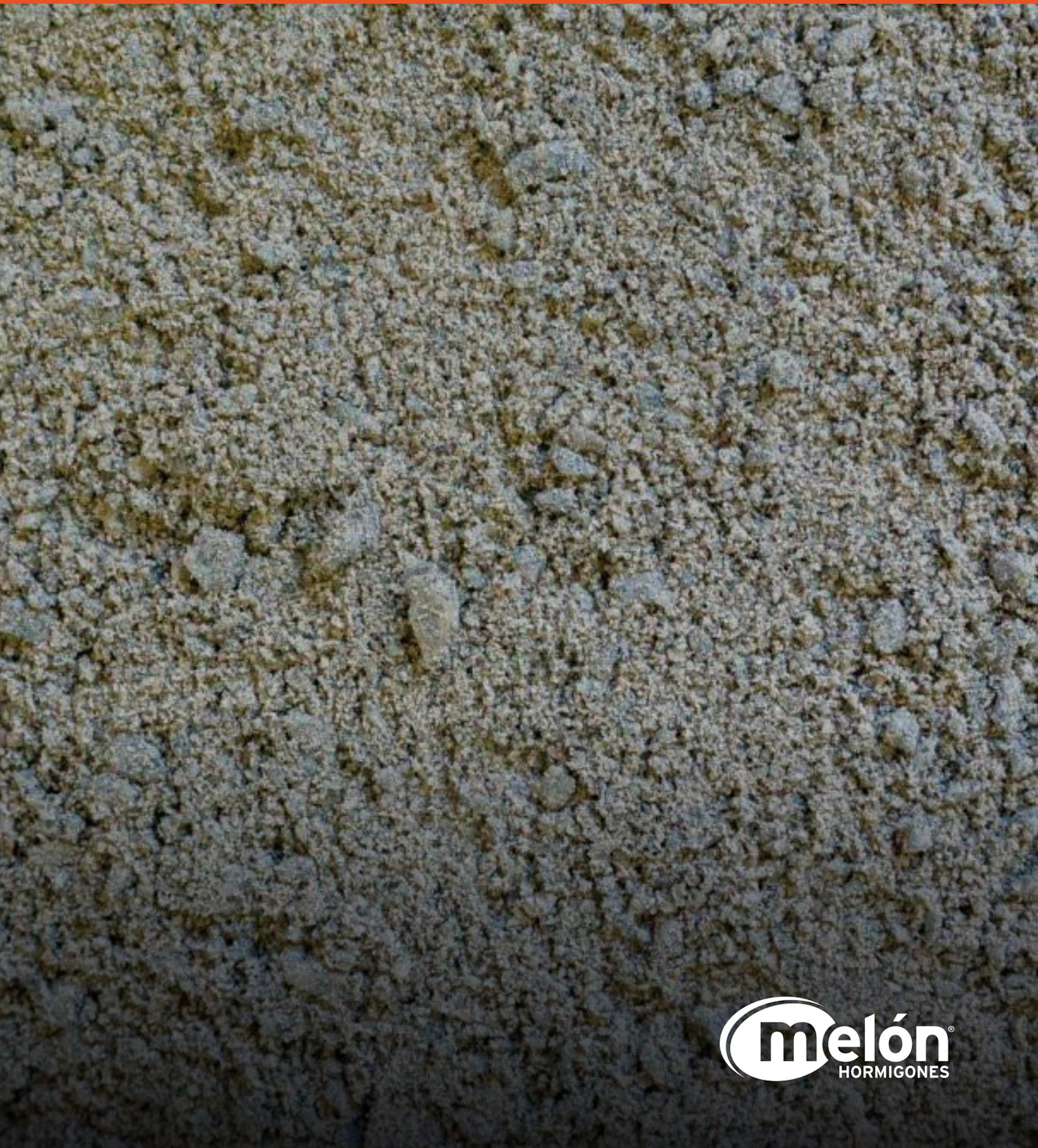
Hormigón y Mortero premezclado seco, es un producto especial creado para ser utilizado en zonas muy alejadas, complicadas de acceso o que posean algún requerimiento especial de descarga en obra. Nuestra oferta comercial incluye entrega de instrucciones para activar con agua y aditivo en terreno y así llegar a la resistencia potencial solicitada.
